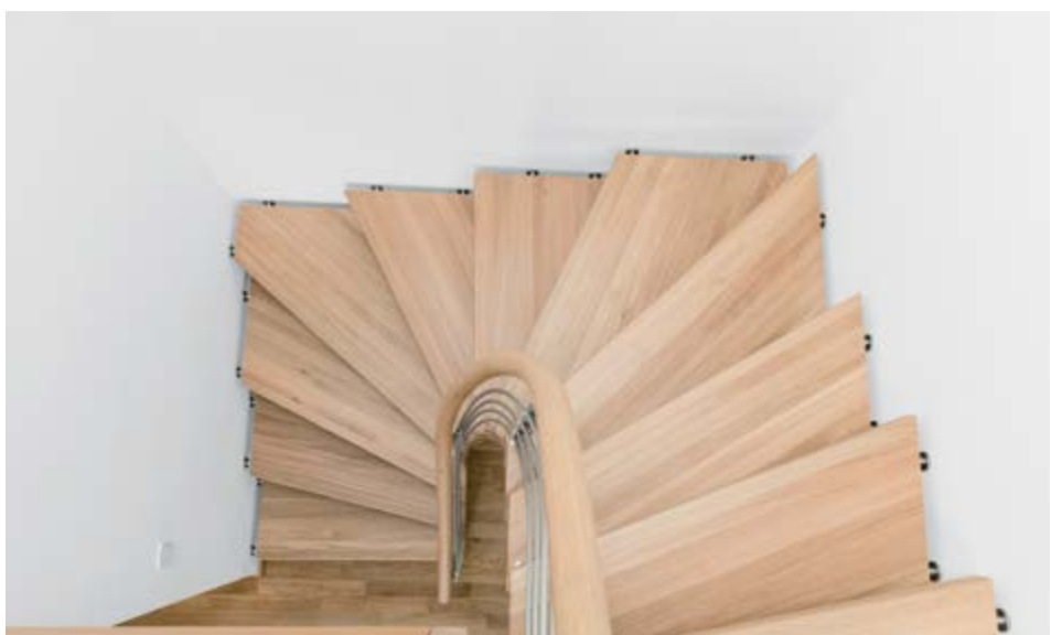
Treppe EASYLINE aus Eiche MB gefertigt, Geländer als Edelstahlreilingeländer mit Rund- handlaufkrümmung sowie gebogenen Reling- gurten aus Edelstahl, Tragbolzen zwischen den Stufen aus Edelstahl.
