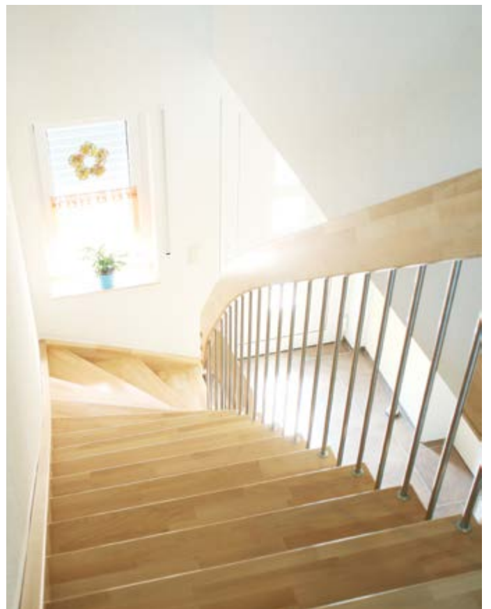
STANDARDLINE in Holzart Buche durchgehende Lamelle blockverleimt. Stäbe in Edelstahl und Tragbolzen aus Buche gefertigt. Ausführung der Handläufe in geschwungener Form. Wandwange in gebolzter Ausführung. STo20
