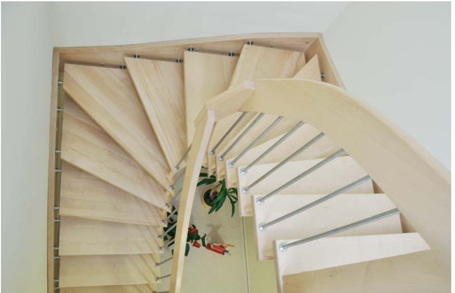
STANDARDLINE in Holzart Buche durchgehende Lamelle blockverleimt. Stäbe in Edelstahl und Tragbolzen aus Buche gefertigt. Ausführung der Handläufe in geschwungener Form. Wandwange in gebolzter Ausführung. STo20
