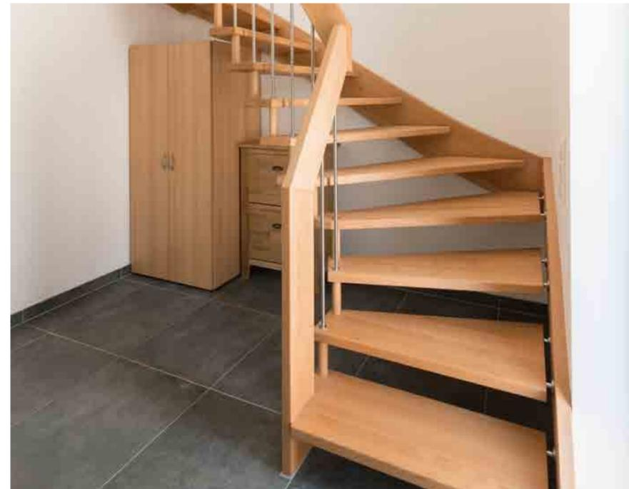
StandardLine in der Holzart Buche, durchgehende Lamelle blockverleimt. Stäbe in Edelstahl, Tragbolzen aus Buche gefertigt, Wandwange in gebolzter Ausführung. Oberfläche geölt.
