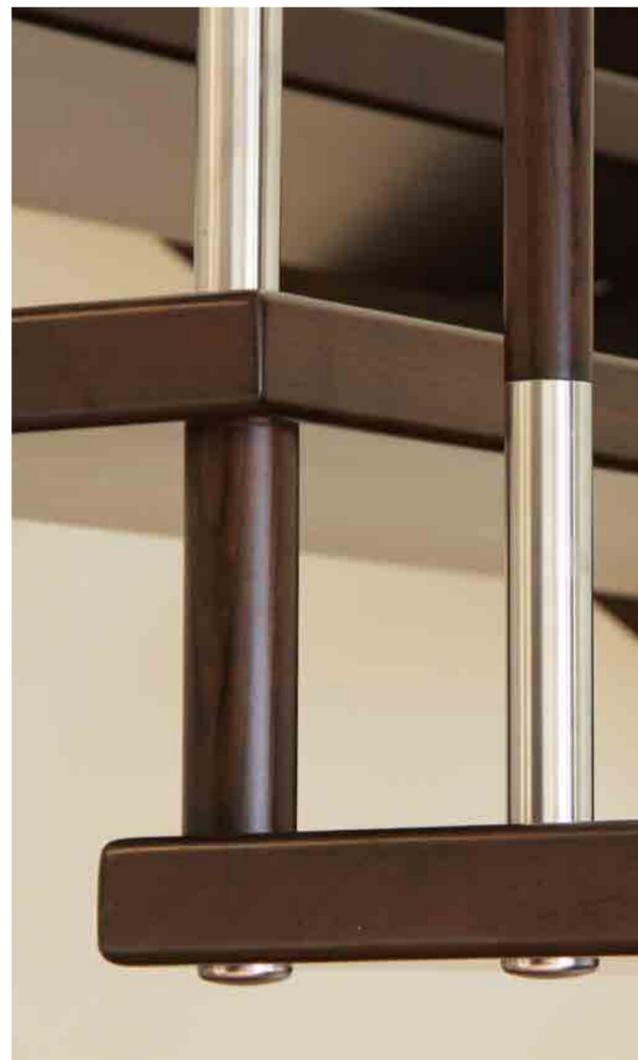
StandardLine in Holzart Buche mit durchgehender Lamelle blockverleimt. Oberfläche gebeizt und lackiert. Stäbe als Holz-/Edelstahlkombination. Tragbolzen Buche gebeizt. Handlaufausführung mit Krümmung. Pfosten 90 x 90 mm mit dekorativem Dachschnitt und Kehle.
