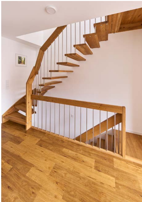
Basicline in Holzart Wild- eiche mit durch- gehender Lamelle. Oberfläche geölt mit Stäben und Tragbolzen aus Edelstahl gefertigt.
