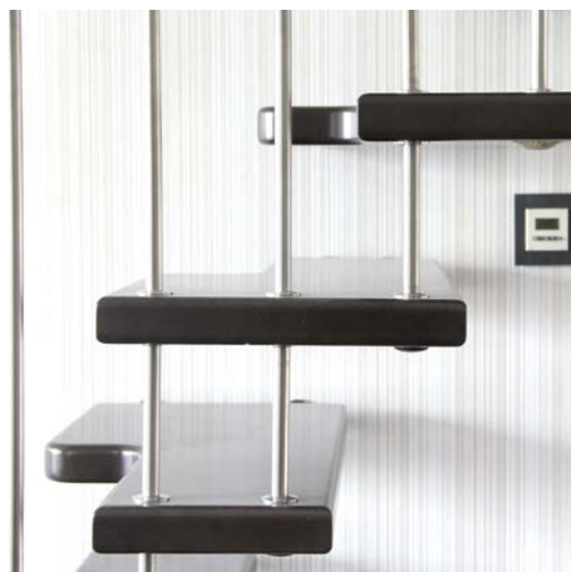
Treppe aus Buche Massivholz blockverleimt gefertigt mit einer dunkel geölten Oberfläche. Mit Stäben und Distanzen aus Edelstahl.
